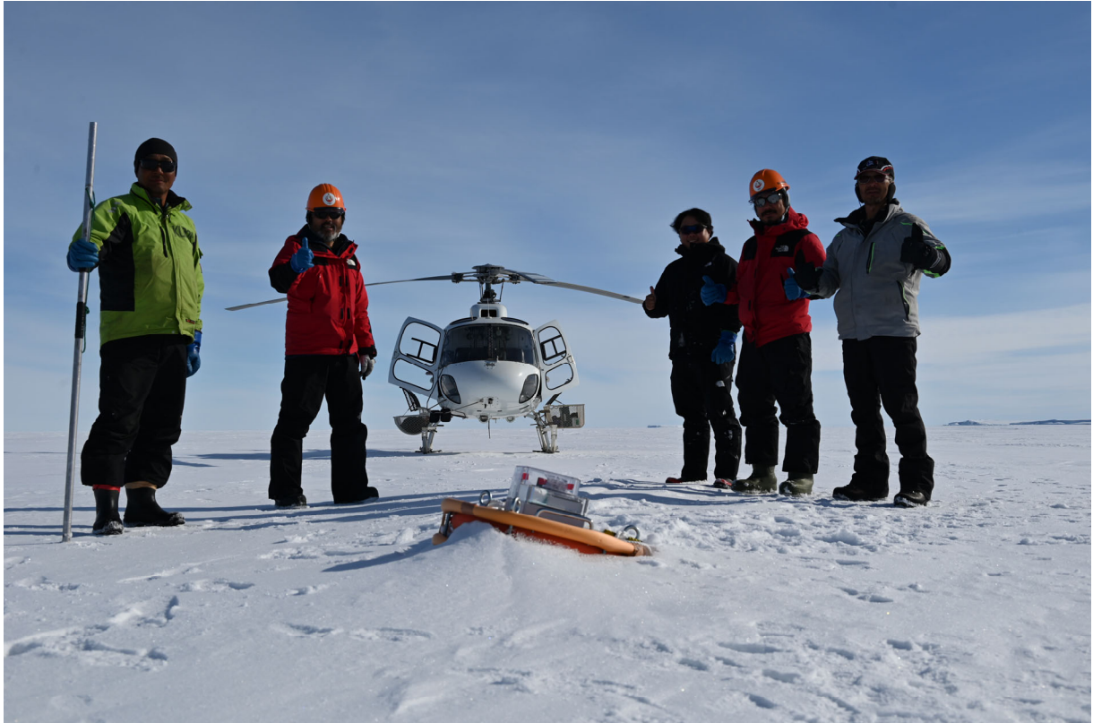
図4：定着氷上にヘリコプターで降り立ち、波浪ブイ近傍で氷厚を計測 12月に設置したブイに2月に来訪、ブイは雪に埋まっている。
